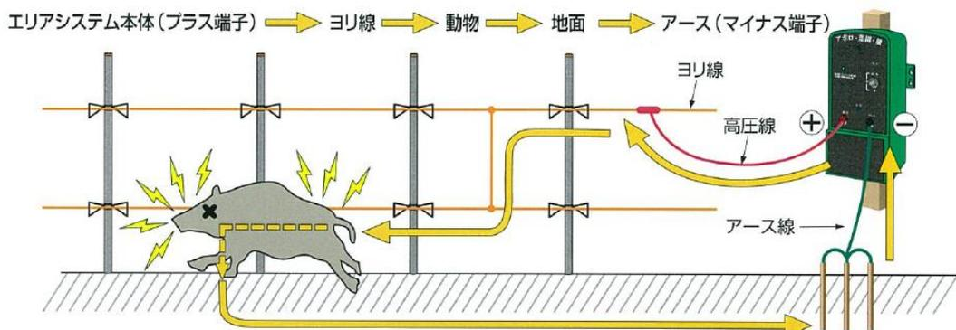
※電圧のかかっているさく線に、動物が触れた時に衝撃電流が循環し、強烈な電気ショックを感じます
