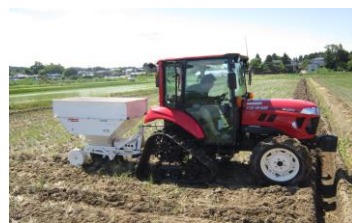
籾殻補助暗渠 モミサブロー
