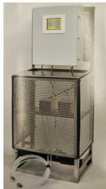
○ネタフィムジャパン㈱の液肥混入機 「ミニシステム」で灌水管理 ○液肥は1液式と2液式から選択
