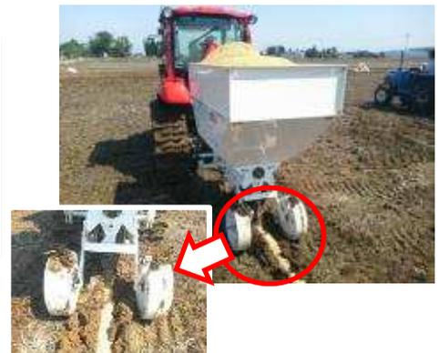
耕盤破碎、補助暗渠の施工で透排水性を確保 (水田の畑地転換)
