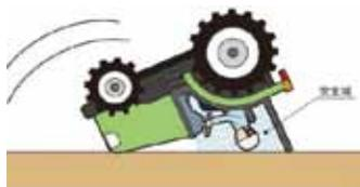
転落・転倒時に、安全キャブ・フレームは安全域を確保してくれます
