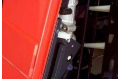
角材タインレールの採用 (鉄板から角材へ変更)
