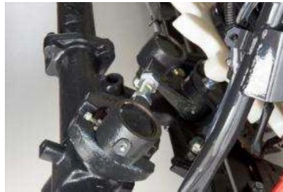
刃刃駆動 (支点にベアリングを採用)
