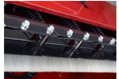
2重わら押さえ板 (交換式わら押さえ板採用)
