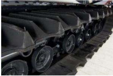
肉厚クローラの採用 (ゴムの厚みが厚い)
