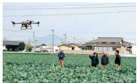
上空から農薬散布を行うドローン
