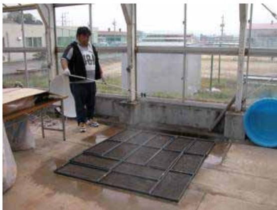
水散布で錆をすすめる
